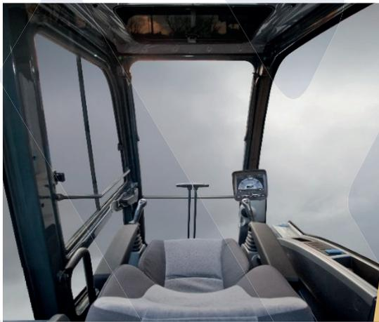
Uma das cabines mais confortáveis e modernas da categoria, proporciona ao operador ampla visão e baixo índice de ruídos. Joysticks ergonômicos e descanso de braço ajustável, ambos com regulagem de altura e distância.
