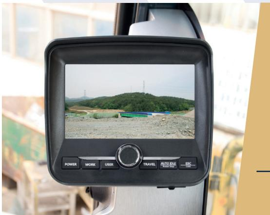
A câmera de ré é um importante item de segurança que permite a ampla visão da região traseira da máquina. A câmera é dotada de led infravermelho gerando imagens mesmo sem a presença de luz no ambiente.
